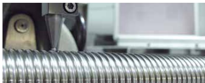
Messung der Steigungsgenauigkeit
